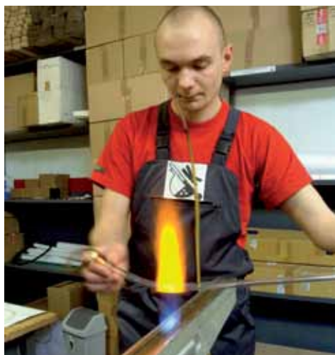
Produkcja rur neonowych – źródło Kapilar.
