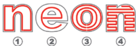
Sposoby odwzorowania liter za pomocą rur neonowych (1 – po obrysie, 2- przez środek, 3- mieszane, 4 – raster neonowy). (oprac. własne).
