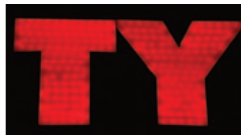
Rysunek 4 Przykład nieprawidłowego zaprojektowanego systemu oświetlenia LED w literach przestrzennych. (oprac. własne).
